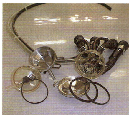
ミルククロー ブリードホールが目詰まりしていると生乳の流れがスムーズいきません。
