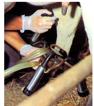
写真5 ユニット装着は空気をしっかり遮断
