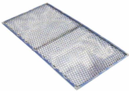
エキスバンドメタルにフレームを付け、網の目を平らにしたもの。専用ピンで組合せ、上に火山灰等を10cm程度かぶせる。商品名「ヌカラーズ」(資材費約0.6坪 $\text{¥12,000}$ )
