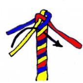
⑤飛び出している子縄を ロープの接している子縄 を飛ばし次の子縄に差し 込む。
