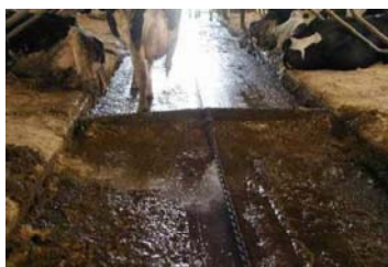
写真11 バーンスクレーパーでの除糞（フリーストール）
