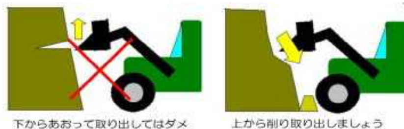
図4 サイレージの取り出し方（バケツでの場合）
