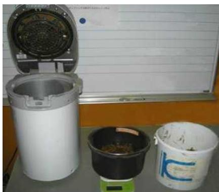
写真14 生ごみ処理機を使って水分を計測するときの道具
