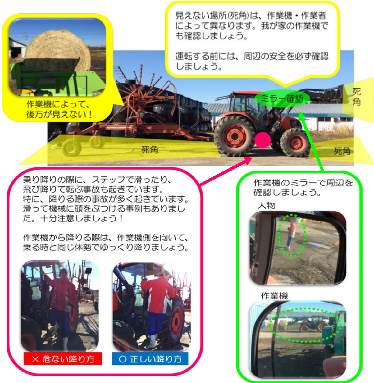
図6 作業機の死角と注意点
