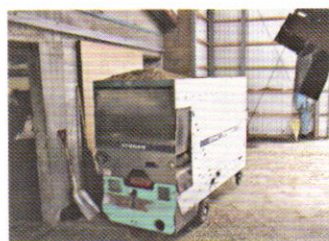
自走給餌車 (約200万円) 〔車幅 115cm 8馬力ガソリンエンジン〕
