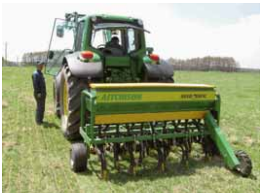
写真7 シードマチックによる放牧地への追播
