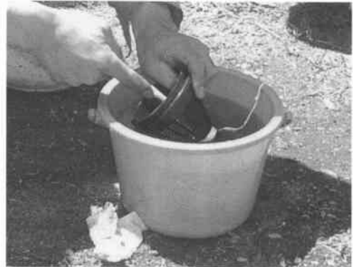
写真3 定期的な清掃は重要 (調圧器の清掃)
