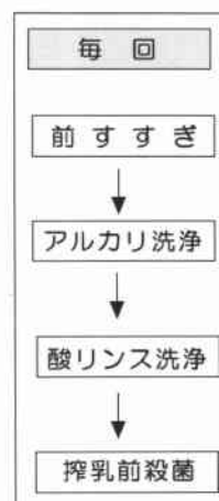
図4 酸リンス方式の洗浄行程
