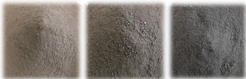
写真Ⅳ-5 根室管内の主な火山性土（風乾土、2mm 篩かけ済み）
