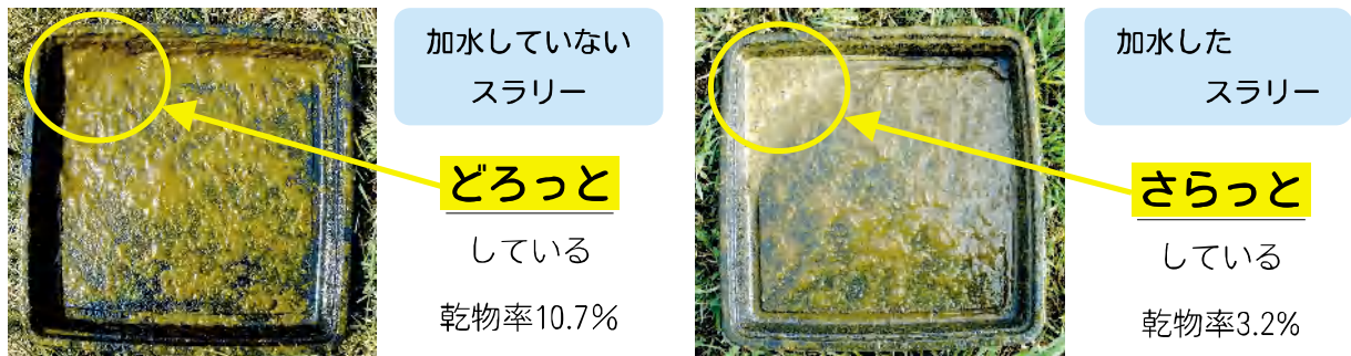
図5 加水していないスラリー（左）と加水したスラリー（右）の性状の違い
