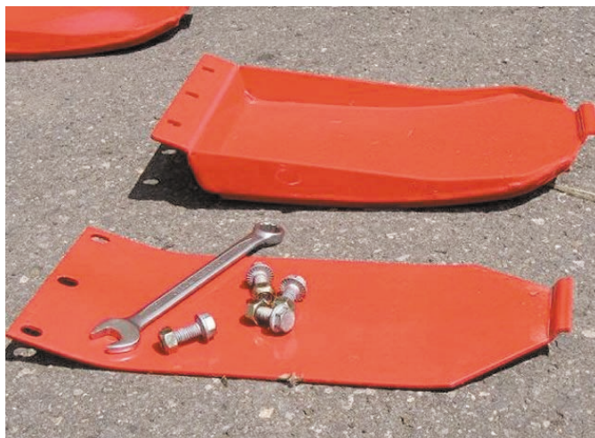
写真2 通常の部品（手前）とオプション部品のソリ（奥）では高さが4cm違う（写真協力：株式会社コーンズ・エージー）
