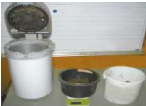
写真8 生ごみ処理機を使って水分を計測するときの道具
