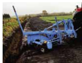
カットソイラ施工
