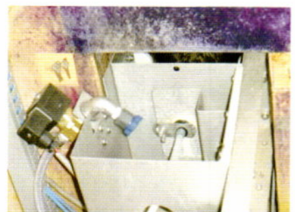
写真10 ニップルの自動洗浄装置は定期的な動作の確認を！
