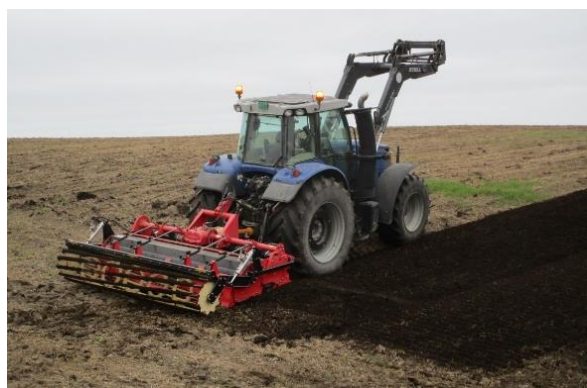
写真2 アッパーロータリーの施工風景
