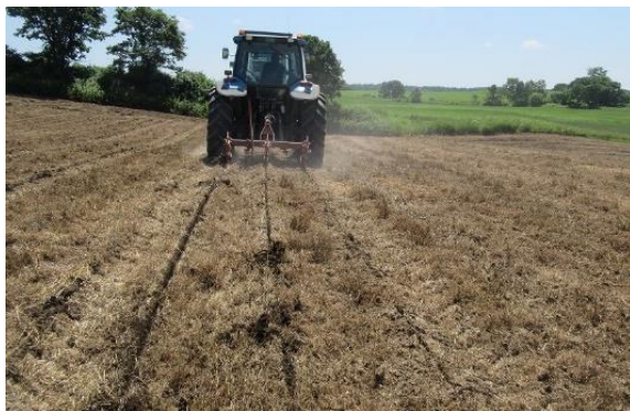
写真1 サブソイラーの施工風景
