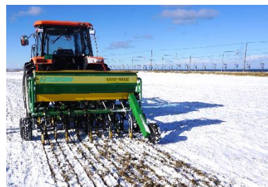
写真4 シードマチックでのフロストシーディング施工
