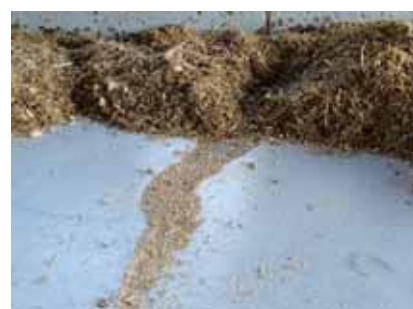
写真5 破損したレジコンに詰まったエサ
