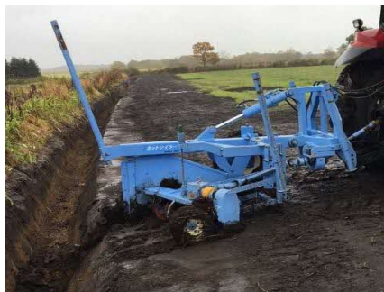
写真1 ①明きょと②カットソイラーの施工 写真2 ③縦孔暗きょの施工
