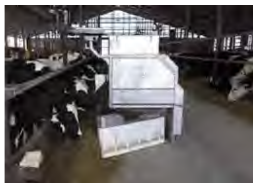
写真2 エサ寄せロボット稼働時
