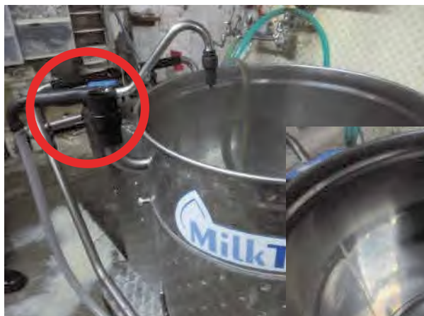
写真5 洗浄時のノズルの装着部分
