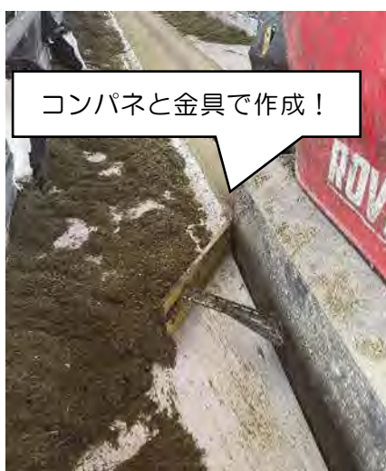
写真1 後付けのスクレーパー
