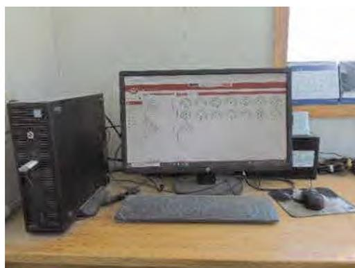
写真4 照明システムの操作管理
