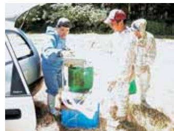
写真2 バンドスプレッダーからのスラリー吐出量測定 (スラリーまみれになりながら、調査するメンバー)
