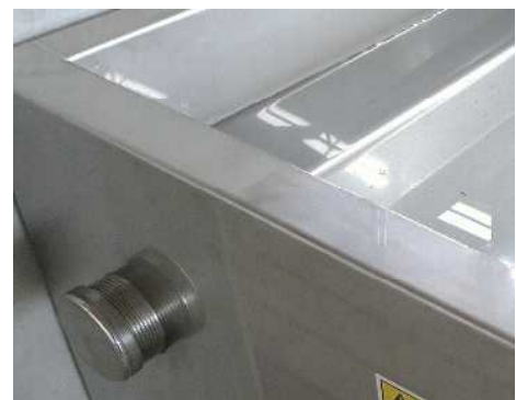
写真3 簡単に開けやすい排水口の例
