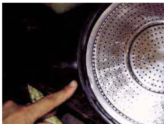
写真 1 劣化したレシーバーのゴムパッキン
