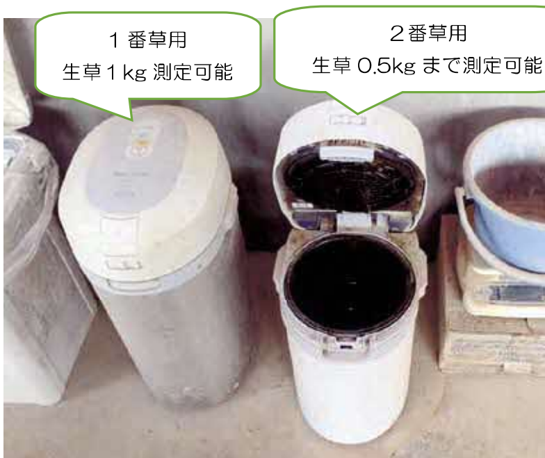
写真 6 乾物測定用生ゴミ処理機
